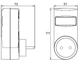
Mobile socket-outlet relays – CCT1A020, CCT1A022 Mobile socket-outlet dimmers – CCT1A021, CCT1A023
